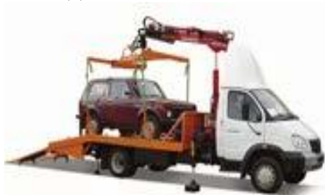
1.11- сурет- Гидроманипуляторы бар эвакуатор: а) - платформа көлбеу; б) - түзу платформа
