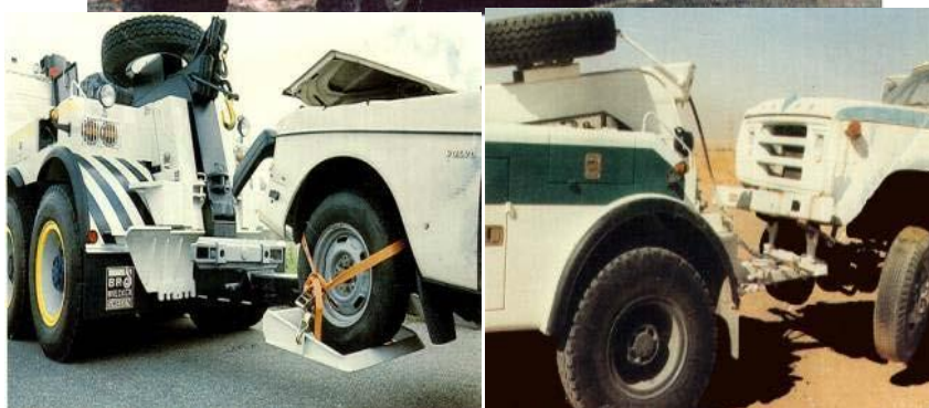
1.3-сурет- Көтеру жабдықтармен жабдықталған ақаулы көліктер арнайы тартып эвакуациялау, қысқыш және құлыптау құрылғылар
