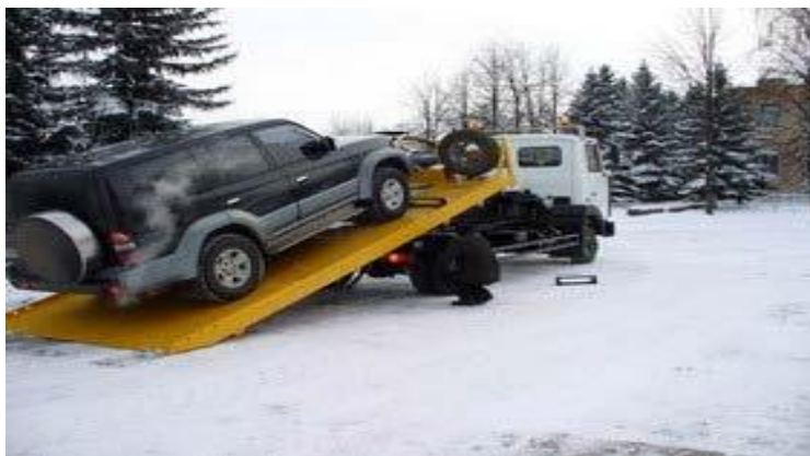
1.13-сурет - Эвакуатор автокөлігі MA3-437940
