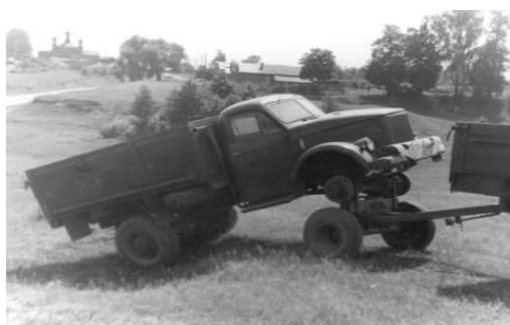
1.6 – сурет-Арба бойынша ақауы бар автокөлік жүктемесінің қосымша жүк эвакуациялау әдісі
