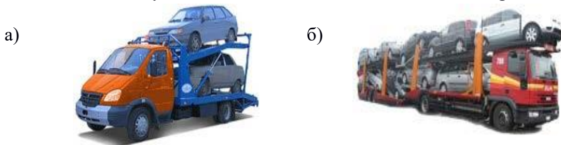
а) екі көлік эвакуациясы, б) үш немесе одан да көп көлік эвакуациясы 1.12-сурет-Екіқабатты эвакуаторлар
