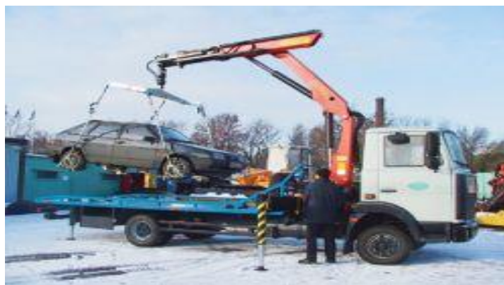
1.15-сурет - Эвакуатор автокөлігі МАЗ- 437043
