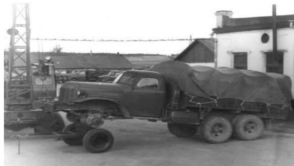
1.6 – сурет-Арба бойынша ақауы бар автокөлік жүктемесінің қосымша жүк эвакуациялау әдісі
