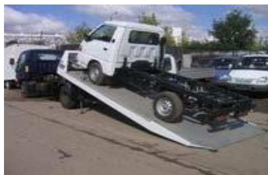
1.10- сурет - Жылжымалы платформасы бар эвакуатор
