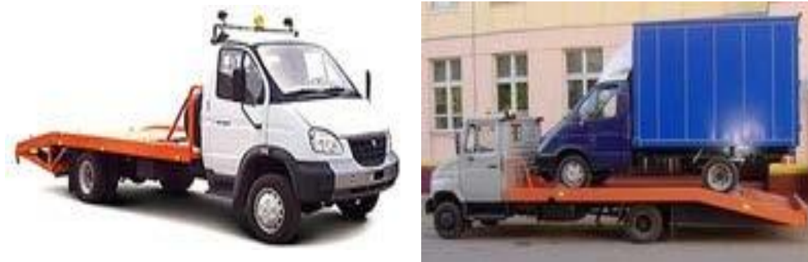
1.9 - сурет-Жүкарбасы бар эвакуаторлар
